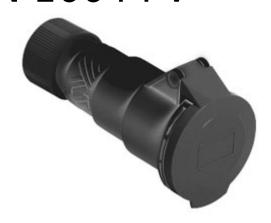
**Produktbeschreibung** Steckdose Produkttyp Mobil PN...PV, PLUSO LS-TYPE Baureihe Schraubanschluss Anschlussart Polzahl 3 polig + 🖳 Position des Schutzleiters Technische Daten Strom 16 A 380 ÷ 415 V Spannung IP44 IP-Schutzart Weitere technische Details 135,00 g Gewicht Betriebstemperatur (min., -25°C ... +40°C
