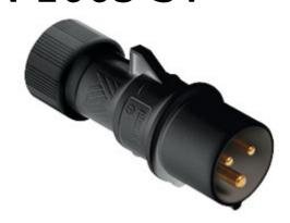
Produktbeschreibung Stecker Mobil Produkttyp PN...SV, PLUSO LS-TYPE Baureihe 2 polig + Position des Schutzleiters Spezifikationen Gerade **Technische Daten** 16 A Strom Spannung 200 ÷ 250 V IP-Schutzart IP44 Weitere technische Details Gewicht 101,70 g Betriebstemperatur (min., -25°C ... +40°C max.)
