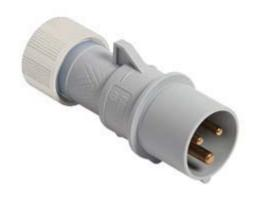
**Produktbeschreibung** Stecker Produkttyp Mobil Baureihe PE...SV. PLUSO Anschlussart Schraubanschluss 2 polig + 🖳 Polzahl Position des Schutzleiters 3 Spezifikationen Gerade **Technische Daten** Strom 16 A Spannung > 50 ÷ 250 V **IP-Schutzart** IP44 Weitere technische Details 103,00 g Betriebstemperatur (min., -25°C ... +40°C max.)
