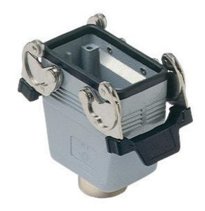
Kupplungsgehäuse, hoch, Gr.57.27, 830V Alu, 2 Bügel, 1xM32 gerade
