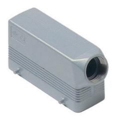
Tüllengehäuse, hoch, Gr.104.27, 830V Alu, 4 Bolzen, 1xM32 seitlich
