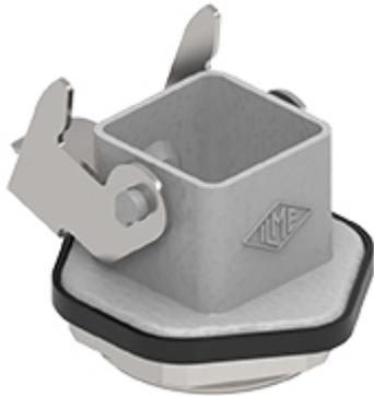
Einschraubgehäuse, Gr.21.21, Alu, 1 starrer Bügel Edelstahl, 1xM32 außen, Profildichtung
