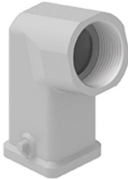
Tüllengehäuse, gewinkelt, Gr.21.21, Zink, 2 Bolzen, 1xM25 seitlich, Dichtung
