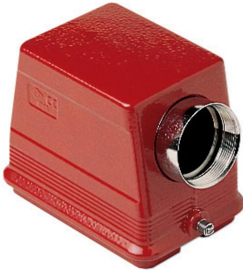
Tüllengehäuse, Gr.104.62, 180°C Alu, 2 Bolzen, 1xM40 seitlich
