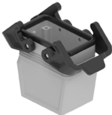
Kupplungsgehäuse, Gr.57.27, JEI Alu, 2 Bügel, 1xM32 gerade, ohne Stutzen
