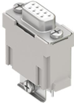
Buchseneinsatz, MIXO, 1ME, 9P+GND, Silber, Schraubanschluss, 5A, 50V, D-SUB, mit T-Verbindung
