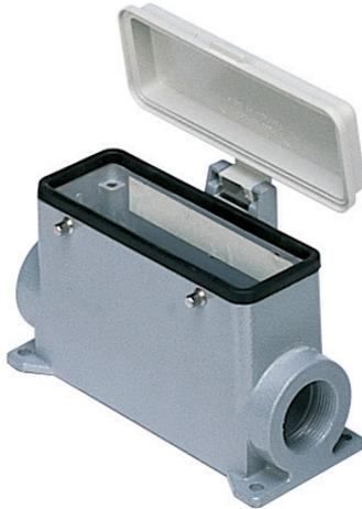
Sockelgehäuse, Gr.104.27, 830V Alu, 4 Bolzen, 1xPg 21 seitlich, Deckel Kunststoff
