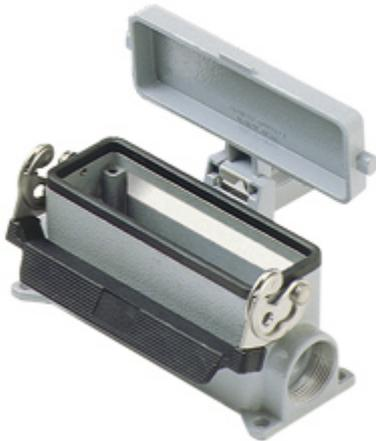
Sockelgehäuse, hoch, Gr.104.27, 830V Alu, 1 Bügel, 2xPg 29 seitlich, Deckel Metall
