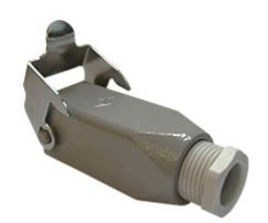
Kupplungsgehäuse, Gr.21.21, Zink, 1 Bügel, 1xPg 11 gerade, mit Kabelverschraubung
